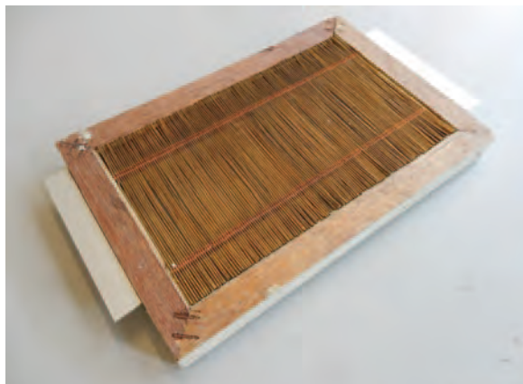
Εικόνα 5. Το τελάρο για την κατασκευή του χαρτιού. Κατασκευή Ν. Μαλακόζης. Φωτογραφία © Γ. Μπουδαλής
