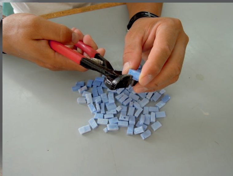
Κοπή ψηφίδων υαλόμαζας. Cutting glass tesserae.
