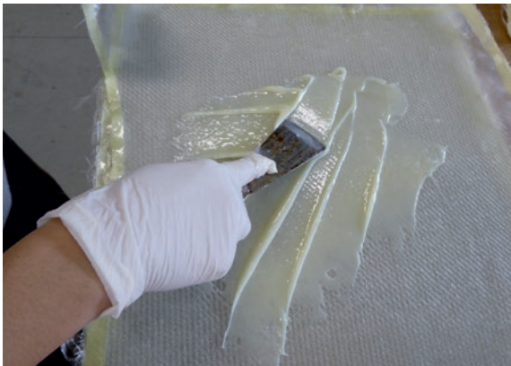
Προετοιμασία του 3D υαλοϋφάσματος. Preparation of the 3D fibreglass fabric.
