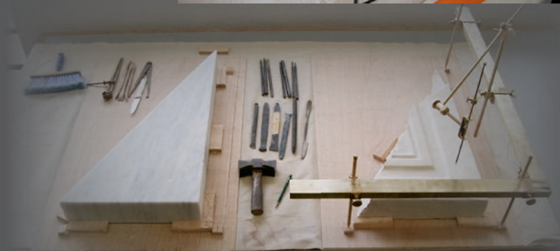
Στάδιο δημιουργίας μαρμαρίνου αντιγράφου από το γύψινο εκμαγείο. Διακρίνονται τα εργαλεία μαρμαρογλυπτικής και ο πονταδόρος.
