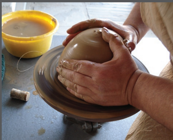
Στάδια κατασκευής κεραμικού αγγείου με τροχό. Stages in the manufacture of a ceramic vessel using a potter's wheel.
